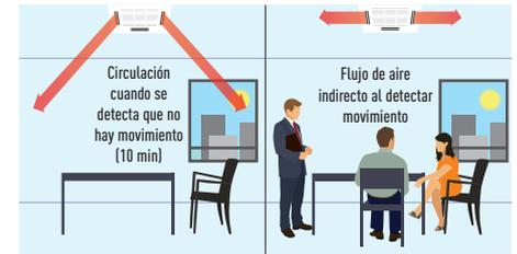
La función de circulación se activa cuando no hay nadie en la sala y mezcla el aire en toda la sala. Minimiza la diferencia de temperaturas tanto en modo calefacción como en modo refrigeración.
